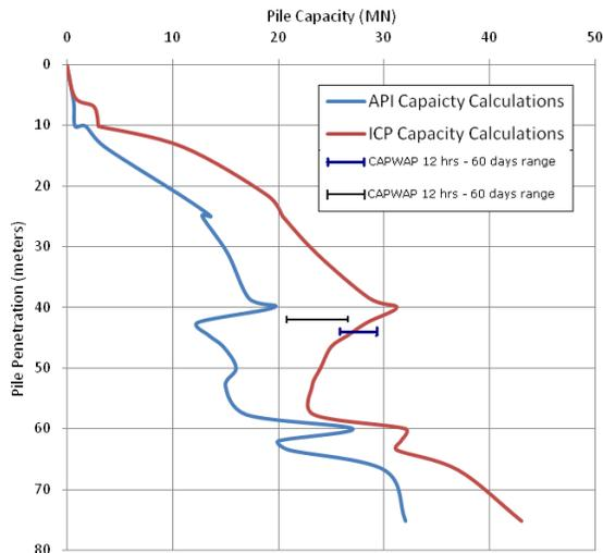
Figure 4 – API RP 2a, ICP and DMS pile capacities
