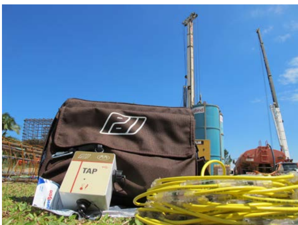
Figura 7: Thermal Wire e unidade de coleta TAP BOX.
