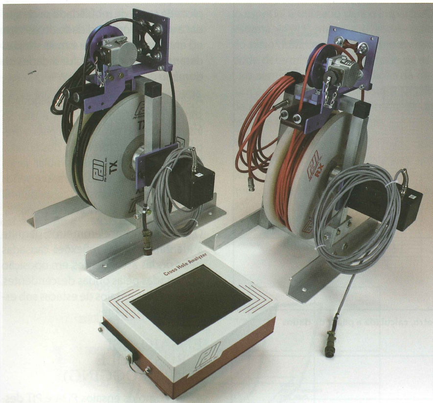
Figura 7 - Equipamento CHAMP para realização dos ensaios CSL, e sondas motorizadas
