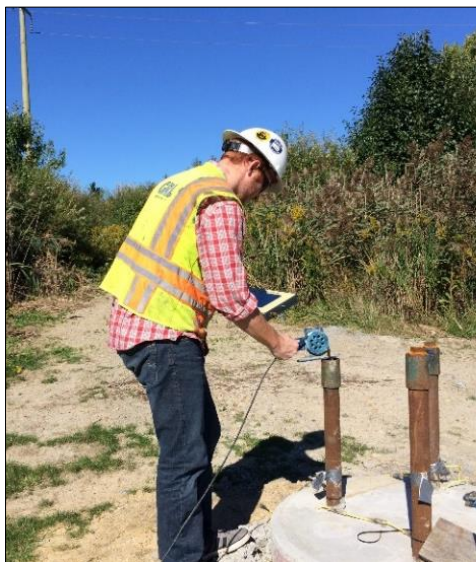
FIG. 7. Thermal Probe Test
