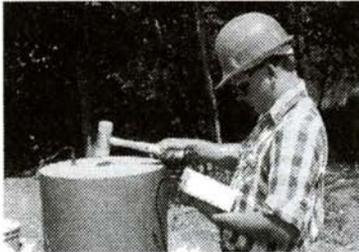
Abb 4 Pfahlintegritätsmessung
