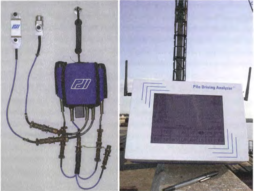
Abbildung 1: Sensoren und Sendeeinheit - Radio am Pfahl (links), Messgerät mit Empfängereinheit, Pile Driving Analyzer von PDI, Modell PAX
