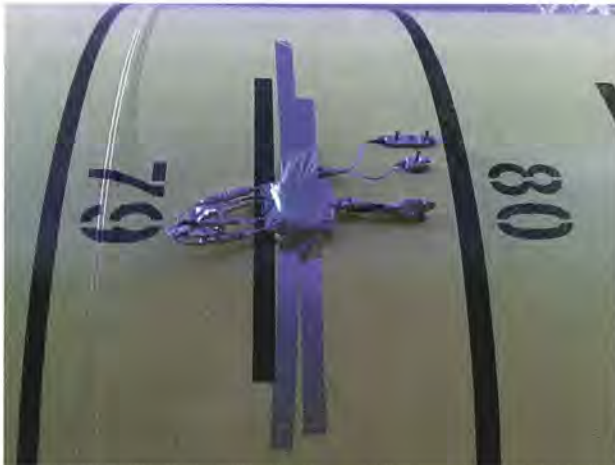
Abbildung 4: Montagezustand: kabellose Messtechnik für dynamische Probelastung
